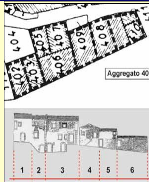
Tav. 2 - Individuazione degli edifici nell'ambito dell'aggregato strutturale.
