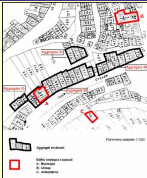
Tav. 1 – Individuazione aggregati strutturali nell'ambito della planimetria catastale.
