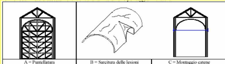
Figura 15. Schemi tipologici di interventi nelle volte e negli archi
